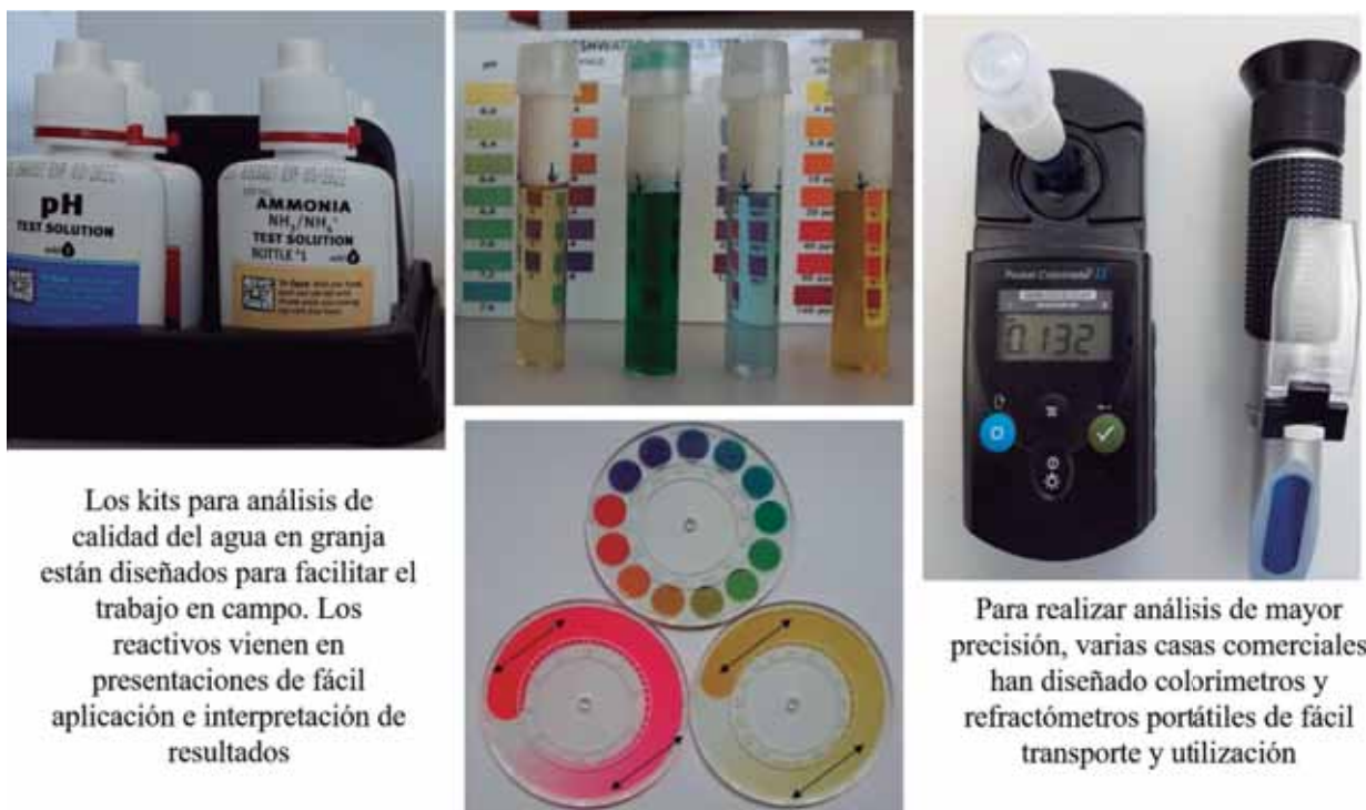
Figura 4. Presentación de algunos de los kits comerciales y equipos portátiles. Se observan resultados para pruebas de pH, amoníaco total, nitritos y nitratos, cuya interpretación se hace comparando los colores desarrollados en los tubos con los impresos en el cuadro y en el disco
